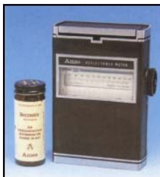
Figura 1: Primeiro glicosímetro de refletância, lançado nos EUA em 1969.
